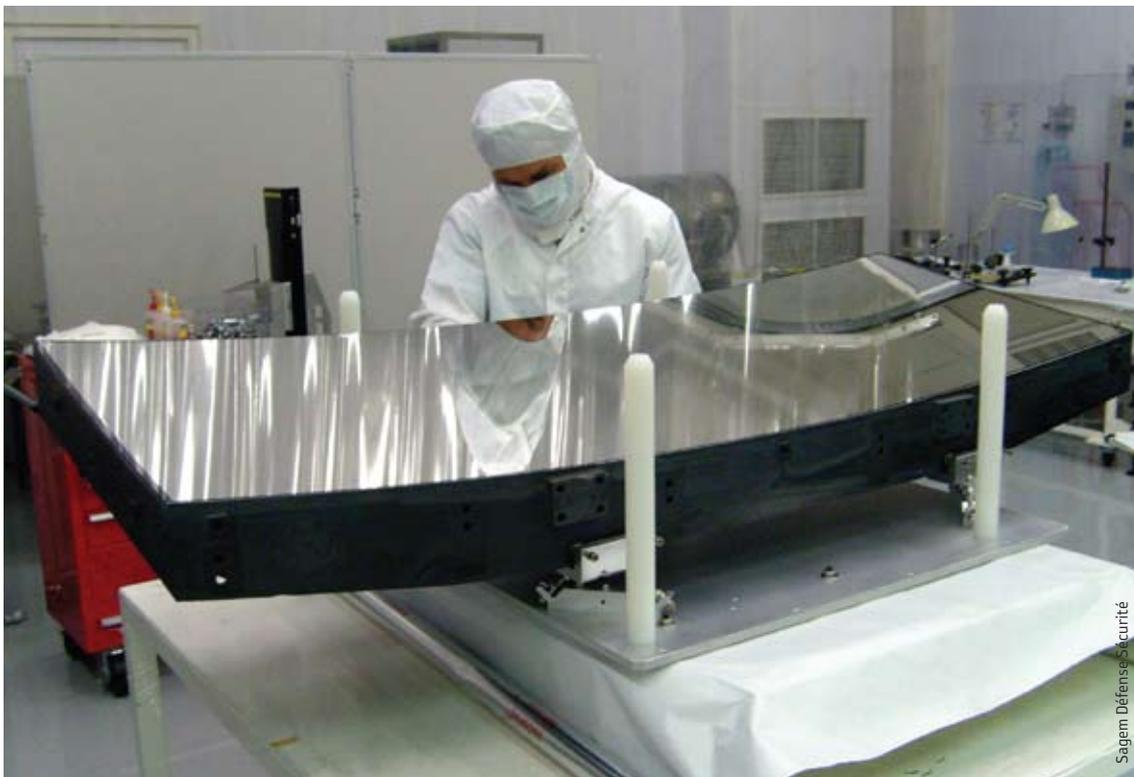
Endkontrolle eines der beiden Hauptspiegel von Gaia
